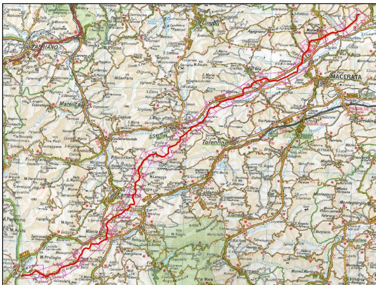
Figura 1 – Corografia con tracciato del metanodotto
