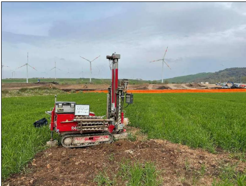
Figura 2 Foto DPSH sostegno 90-10
