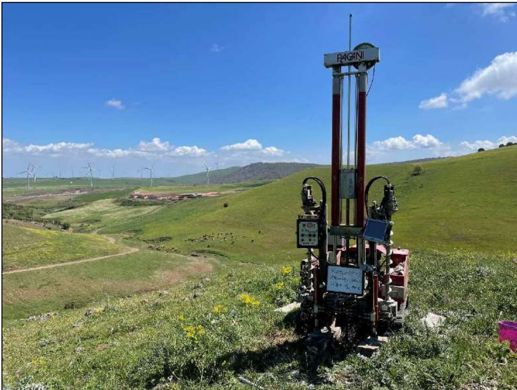
Figura 2 Foto DPSH sostegno 90-6
