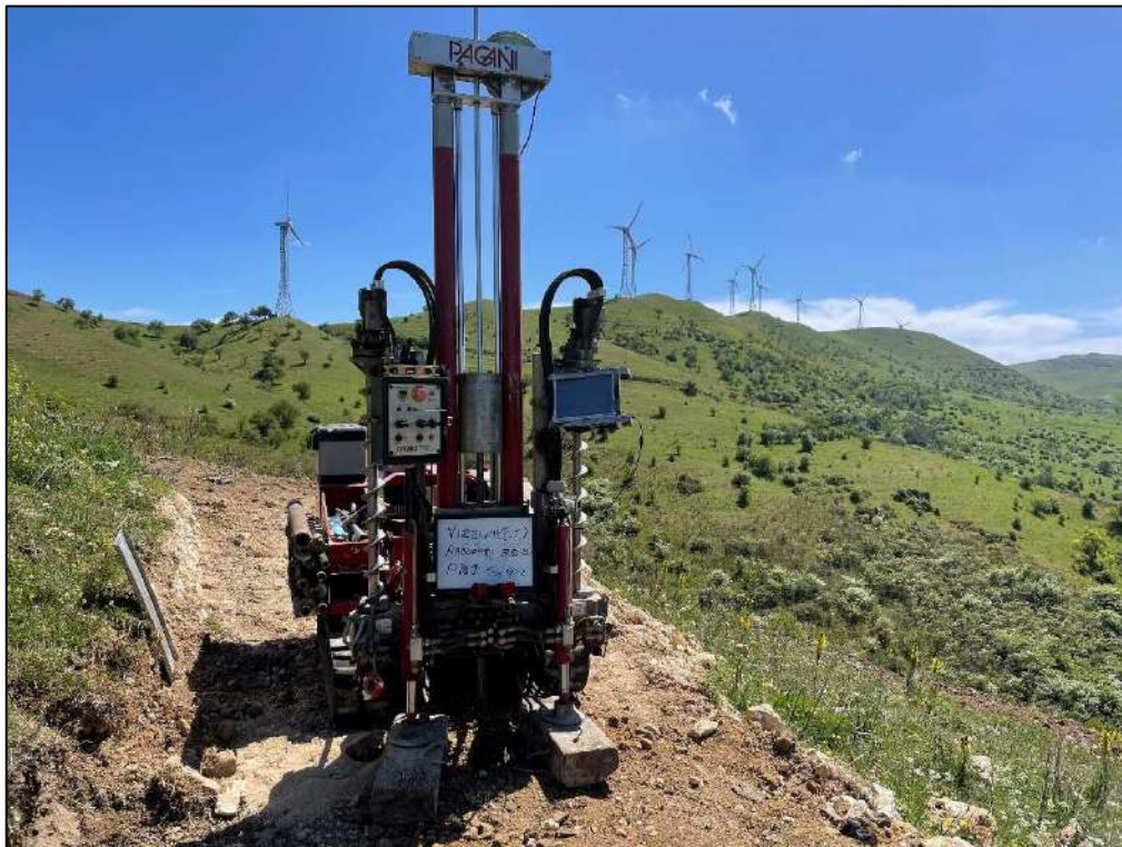
Figura 2 Foto DPSH sostegno 80-2
