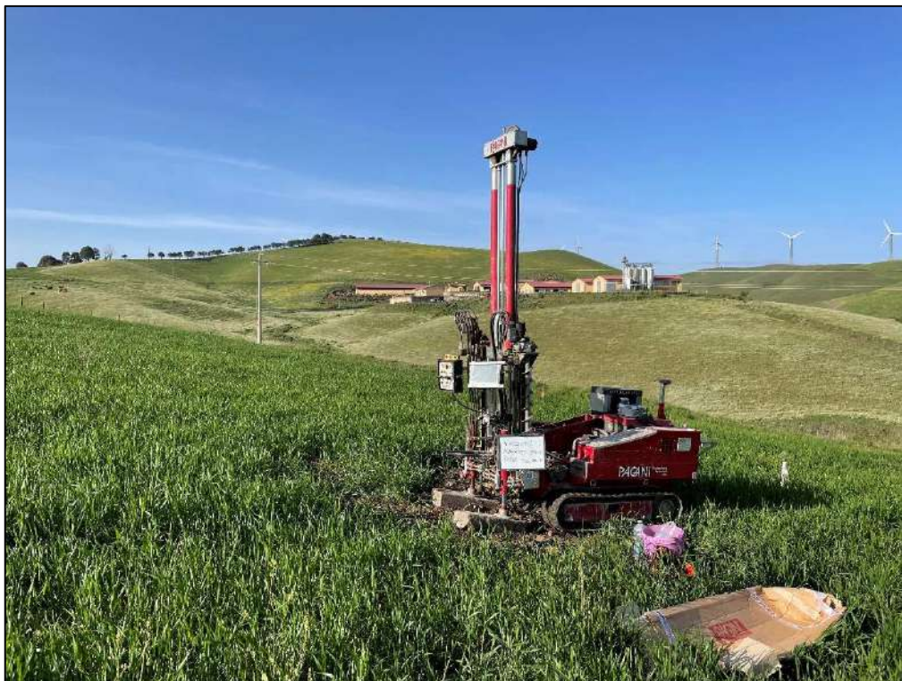
Figura 2 Foto DPSH sostegno 90-9
