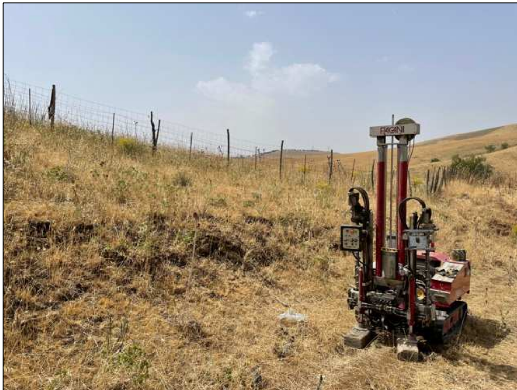
Figura 2 Foto DPSH sostegno 80-3
