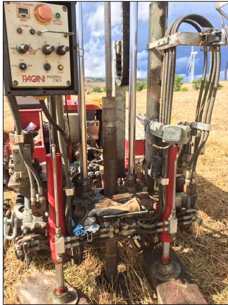
Fig 5 Esempio di campionatore da 60 mm
