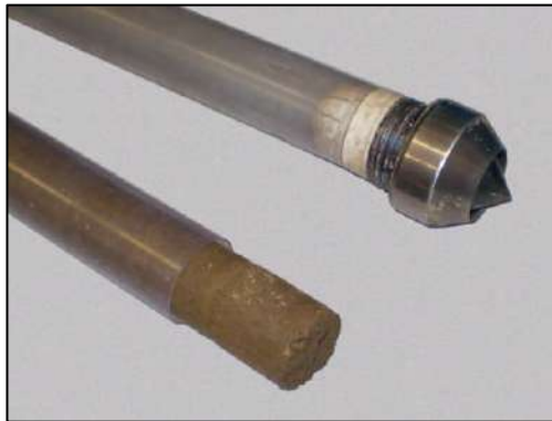
Fig 4 Fustella in pvc da 44 mm
