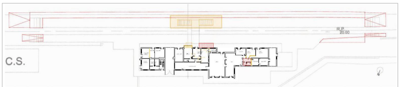
Figura 8: Planimetria ante operam – Individuazione delle demolizioni (in giallo) e degli ampliamenti (in rosso)
