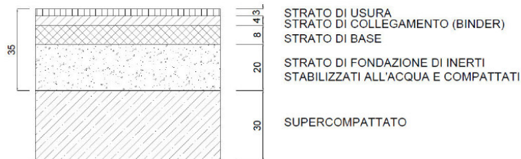
FIGURA 8 SCHEMA DELLA STRATIGRAFIA DELLA SEZIONE STRADALE TIPO
