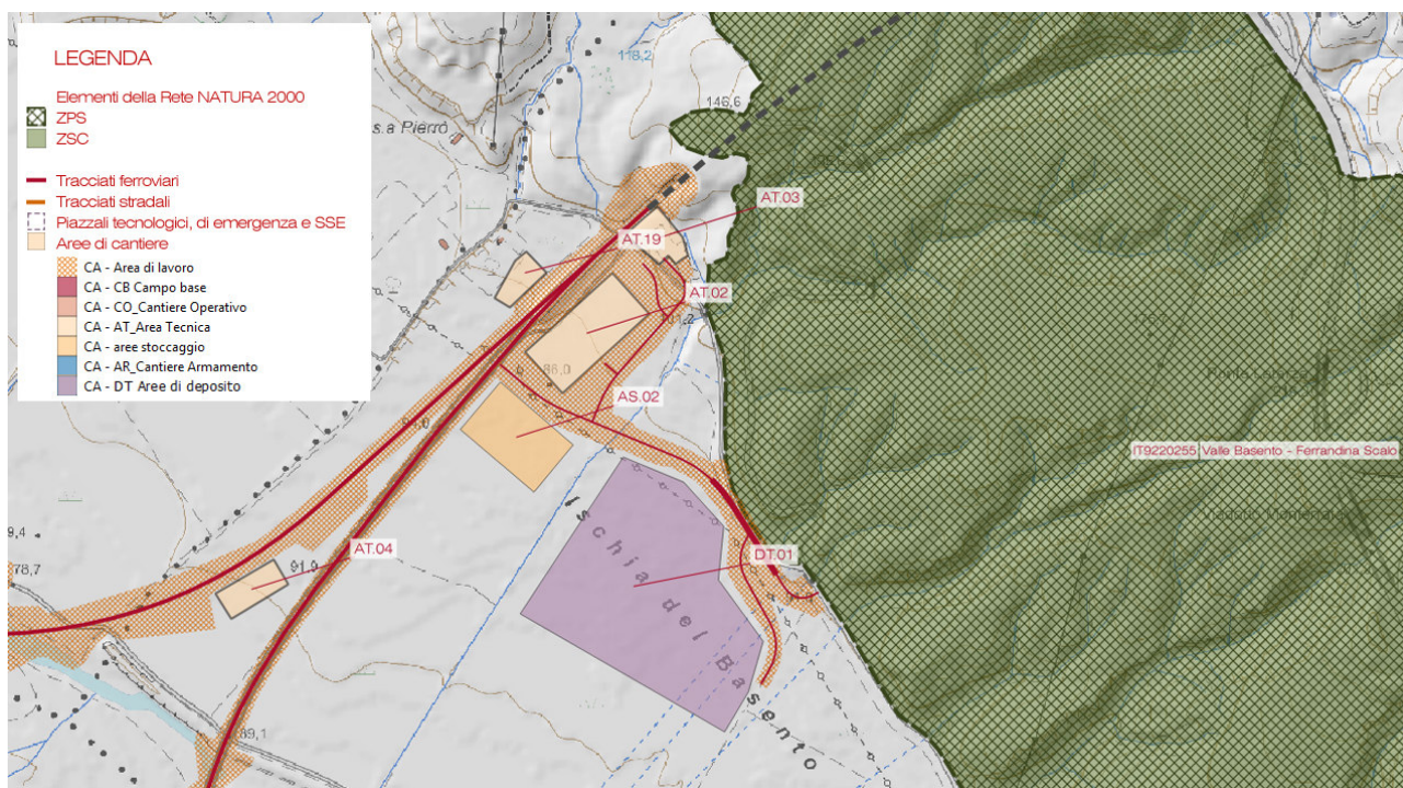
FIGURA 17 LOCALIZZAZIONE DELLE AREE TECNICHE AS.02; AT.02, AT.03 E AT.19 E DELLE AREE DI LAVORO PER LA SISTEMAZIONE DELLA VIABILITÀ DI ACCESSO AI PIAZZALI PRESSO L'IMBOCCO SUD DELLA GALLERIA MIGLIONICO.
