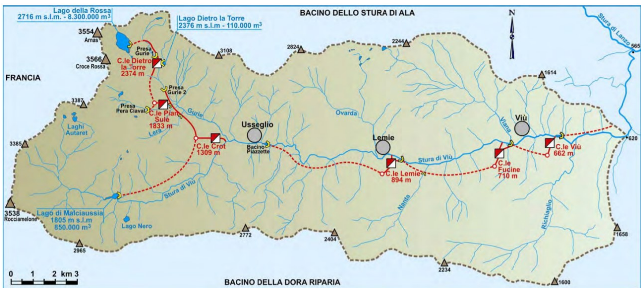
Figura 10. Il complesso sistema di utilizzo delle risorse idriche ai fini idroelettrici del bacino dello Stura di Viù comprende 6 centrali idroelettriche; da monte a valle, sono le seguenti: Dietro la Torre, Pian Sulè, Crot, Lemie, Fucine e Viù. Le prime tre sono alimentate sia da un invaso a gestione "tradizionale" (Malciaussia), sia da un sistema di invasi a pompaggio (Laghi della Rossa e Dietro la Torre). Le altre centrali sono sistemi ad acqua fluente operanti lungo l'asta fluviale dello Stura di Viù a valle di Usseglio.
