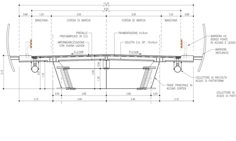
SEZIONE TIPICA TRAVERSO IN PILA
