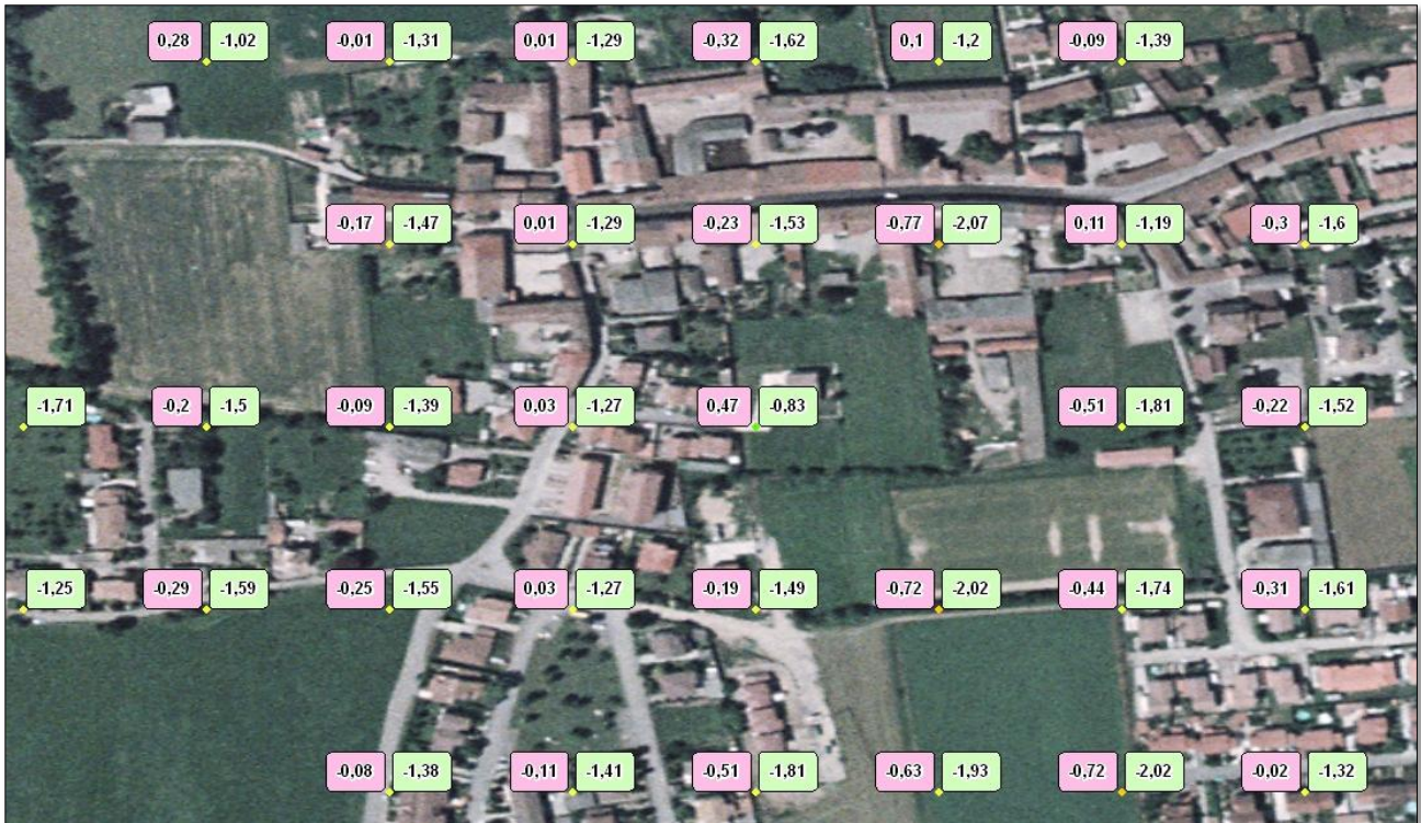
Fig.15 Dati LOCAL scomposti: in rosa i valori originali ed in verde quelli corretti di -1.3 mm/anno.
