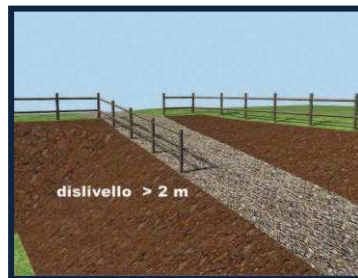
Parapetti lungo le rampe di accesso al fondo dello scavo
