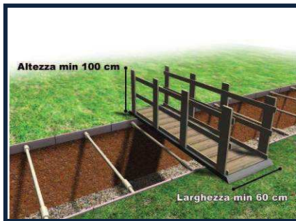
Passerelle per attraversamento dello scavo
