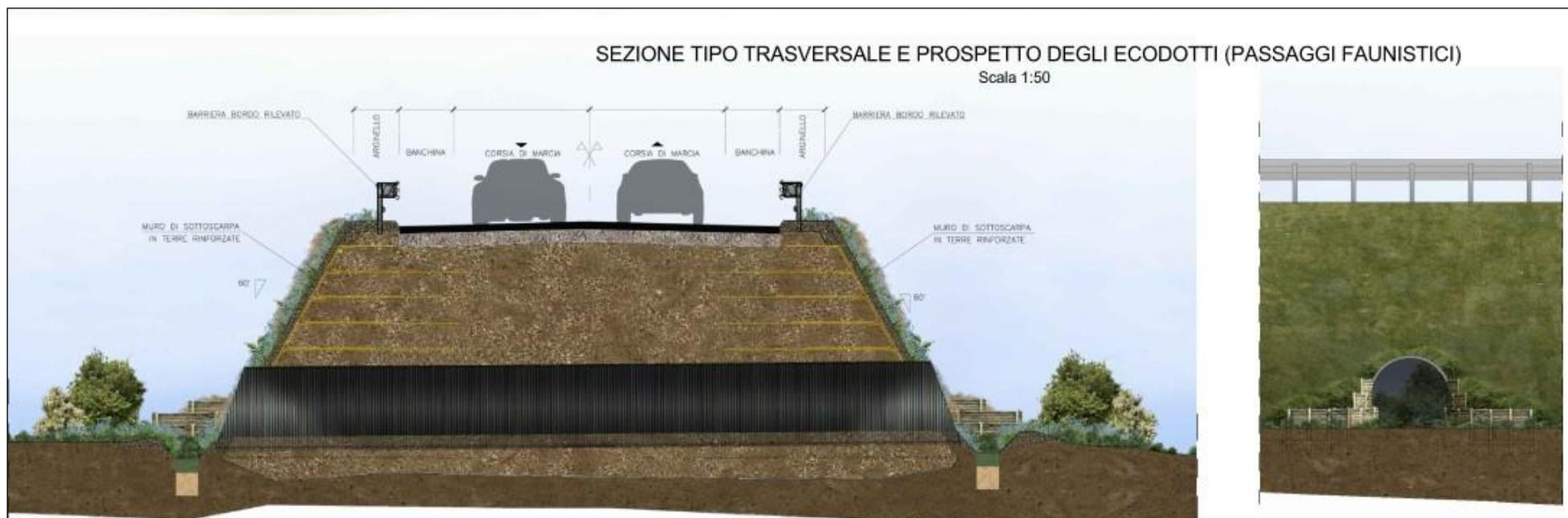
**Figura 8.8 - Sezione trasversale e prospetto dei passaggi faunistici (tratta da progetto preliminare)**
