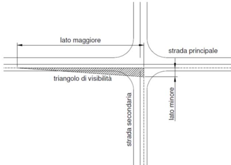
Schema visibilità in rotatoria secondo D.M. 19/04/2006
