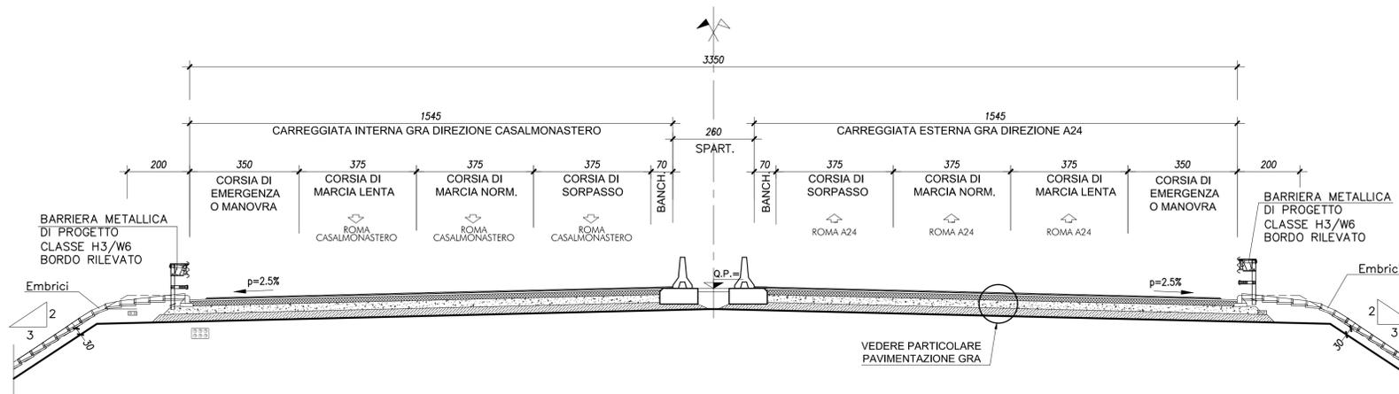
SEZIONE TIPO VIA TIBURTINA SOTTO PONTE GRA - Scala 1:100
