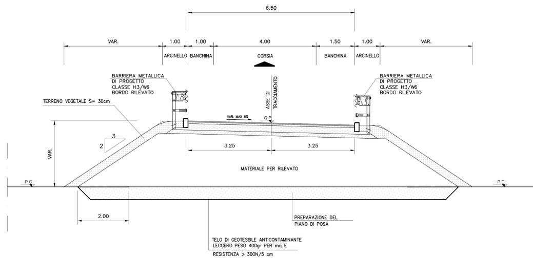
SEZIONE TIPO RAMPA IN AFFIANCAMENTO PIAZZALE ESISTENTE (Ramo Ovest 1) - Scala 1:50 -
