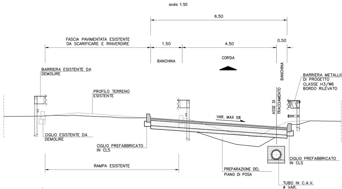
SEZIONE RAMPA DI SVINCOLO DA ADOTTARE PER NOTEVOLI ALLARGAMENTI
