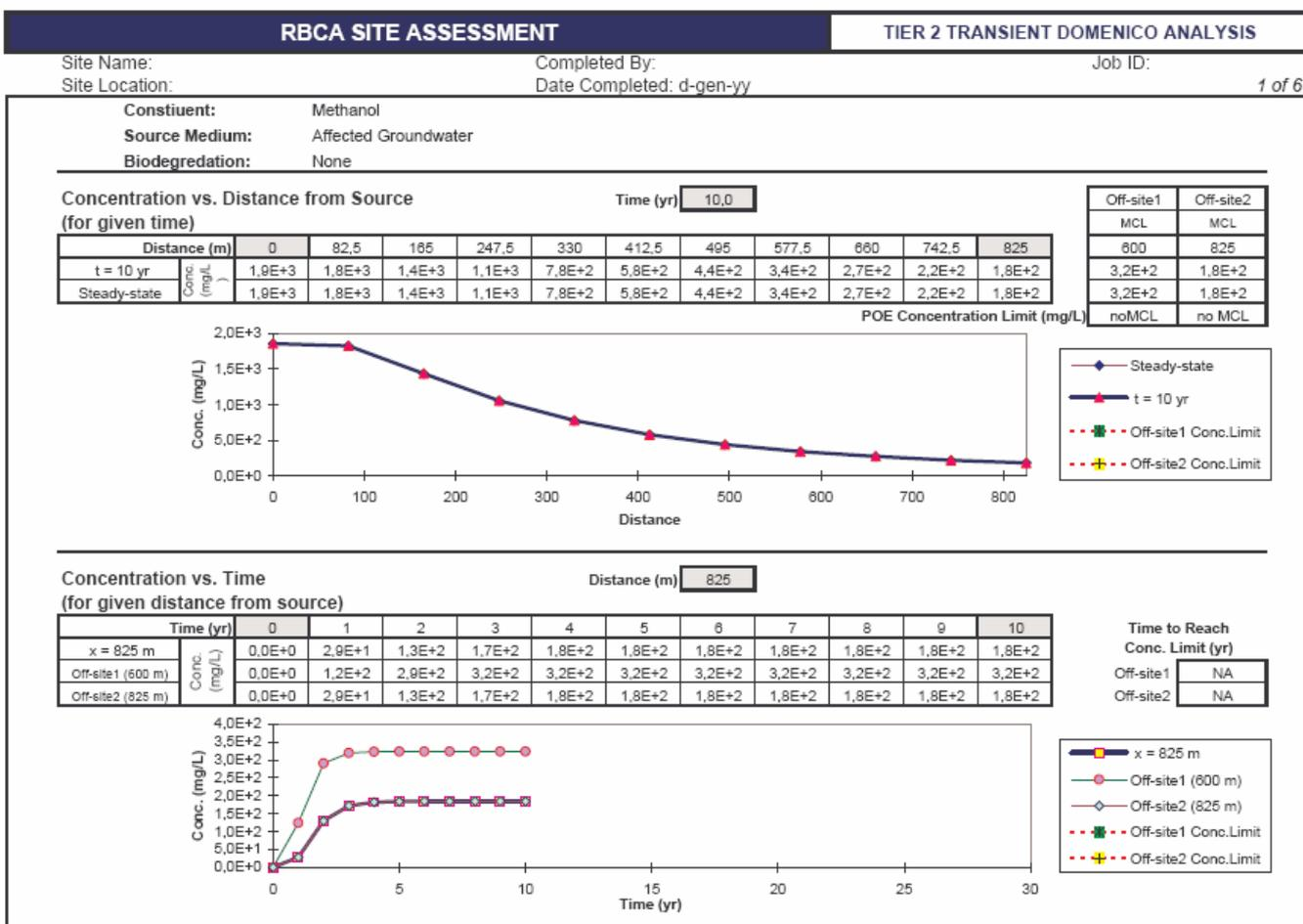
**Fig. 5.5.a: Simulazioni in TRANSITORIO del F&T del composto Metanolo**
