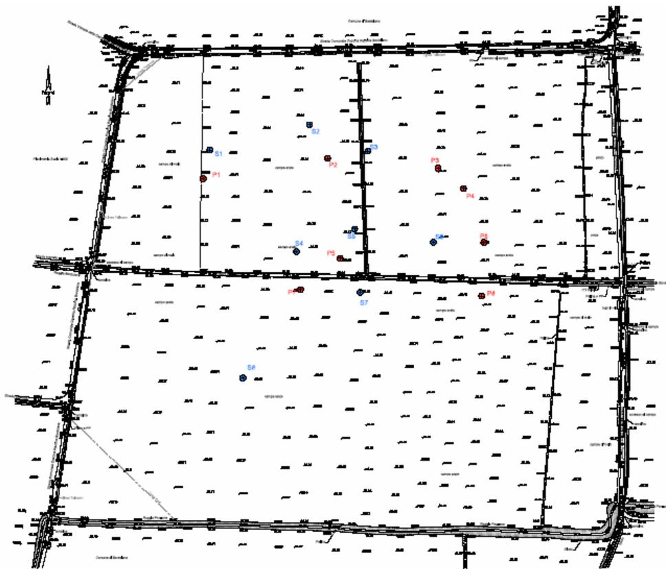
○ P8    SONDAGGIO PENETROMETRICO    ○ S6    SONDAGGIO GEOGNOSTICO
