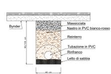
Formazione di scavo a sezione obbligata da 40 cm con posa di letto di sabbia e manto di magrone a protezione della tubazione.
