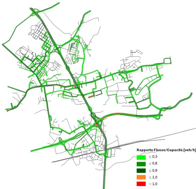
*Figura 52: Rapporto flusso capacità (PROG II – Soluzione a due corsie).*
