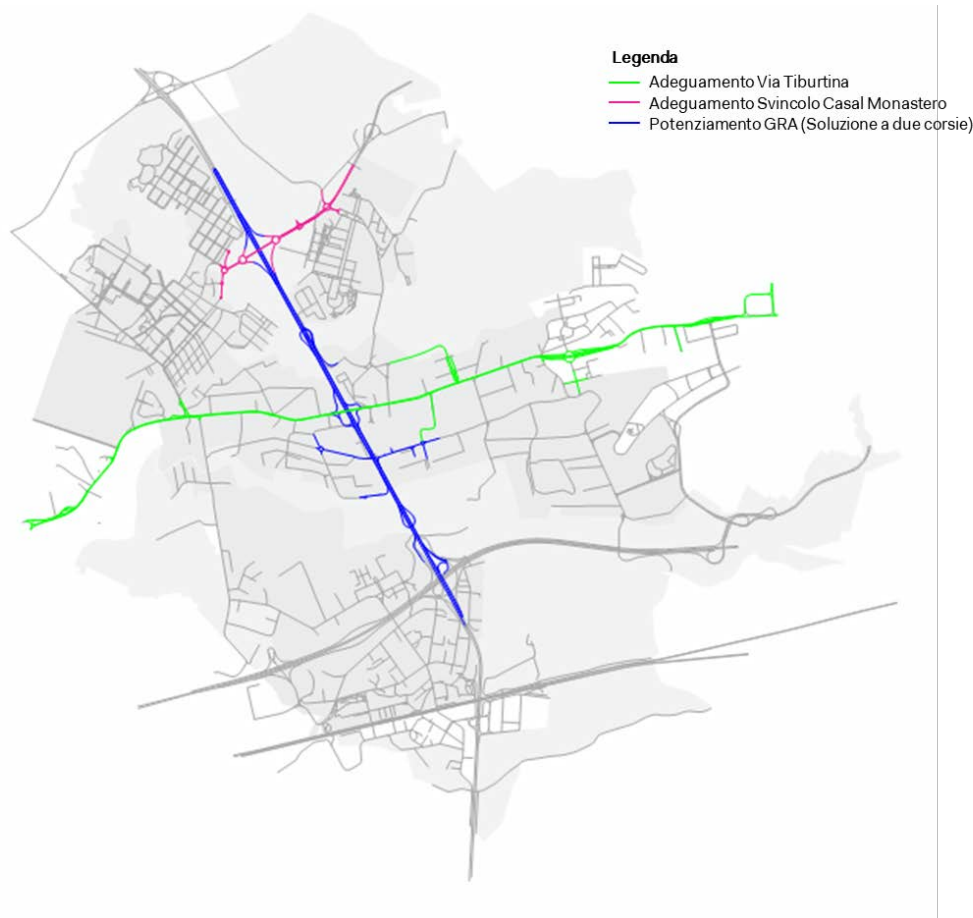
Figura 49. Interventi infrastrutturali dello Scenario di Progetto Fase II – Soluzione a due corsie.
