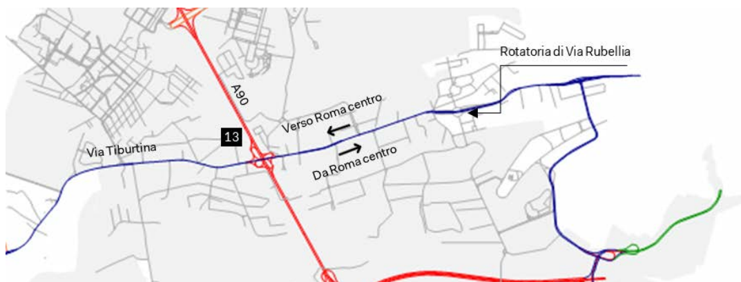
Figura 83. Direzioni per il calcolo del LOS nella viabilità di Via Tiburtina.
