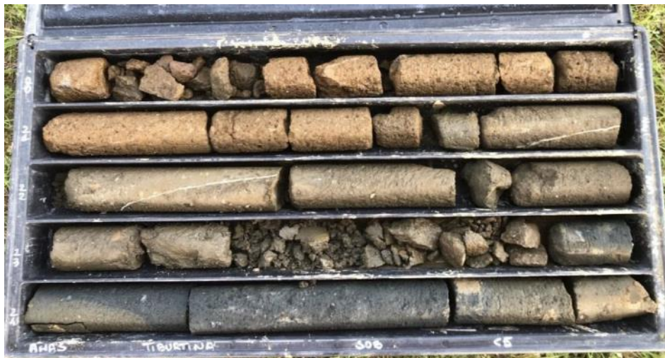
Figura 30: Casseta catalogatrice da 20 a 25 m del sondaggio S08-DH in cui si evidenziano litologie e tufi litoidi
