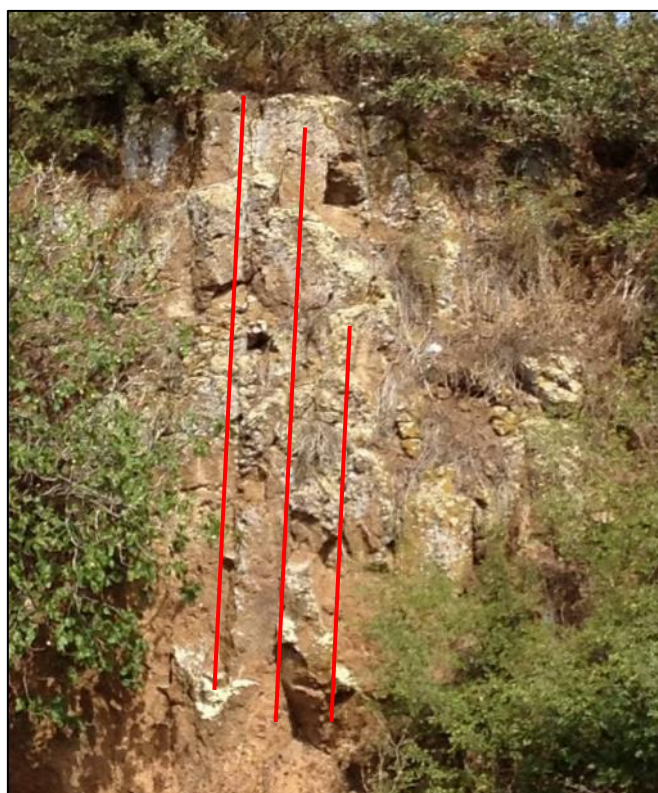
Figura 5: Affioramento di tufo, litoide, interessato da sistemi di fratturazione sub-verticali (in rosso) (non presente nell'area in esame)
