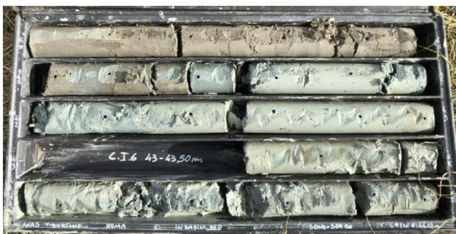
Figura 31: Casseta catalogatrice da 40 a 45 m del sondaggio S09-DH in cui si evidenziano litologie argillose della Formazione di Monte Vaticano
