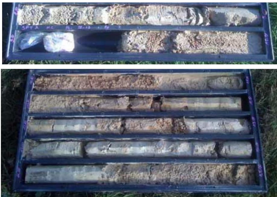
Figura 27: Cassetta catalogatrice da 8 a 15 m del sondaggio pregresso A1 in cui si evidenziano litologie di natura travertinosa
