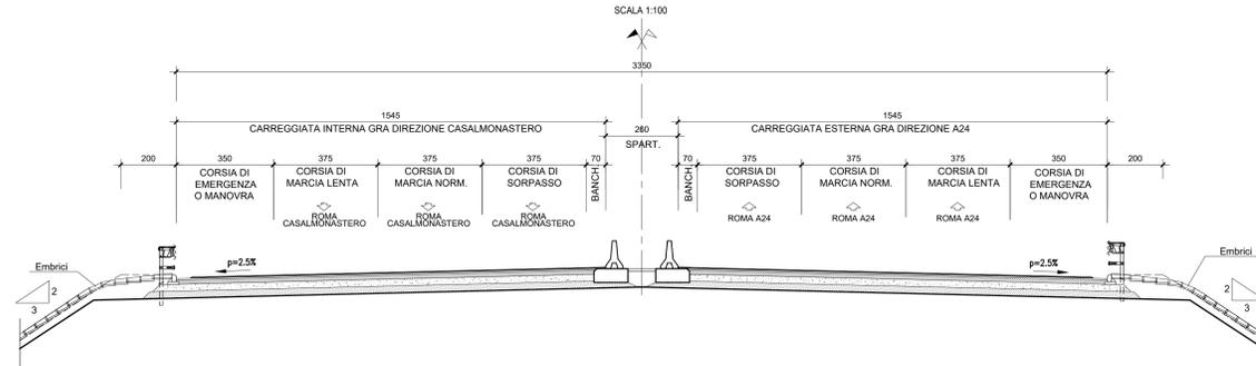
SEZIONE TIPO G.R.A. CON RAMPE IN AFFIANCAMENTO SIA IN RILEVATO CHE IN TRINCEA
