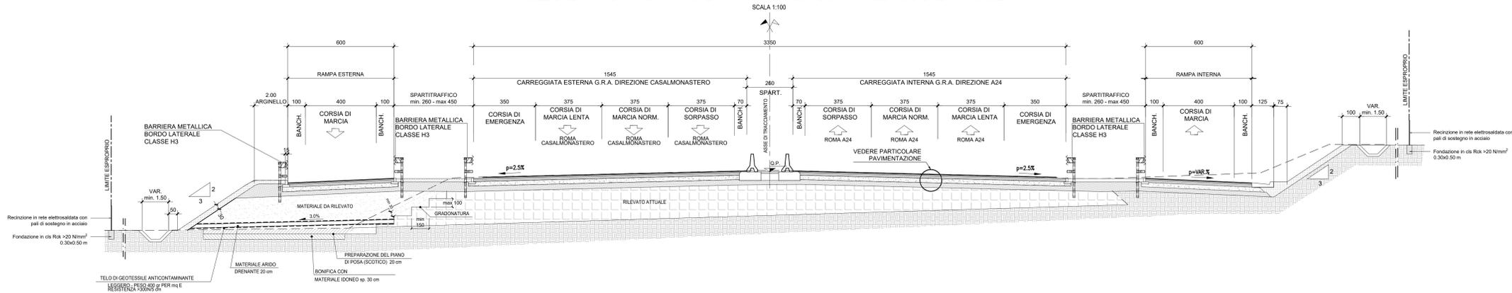
SEZIONE TIPO G.R.A. CON RAMPE IN AFFIANCAMENTO IN RILEVATO E CON MURO DI SOSTEGNO
