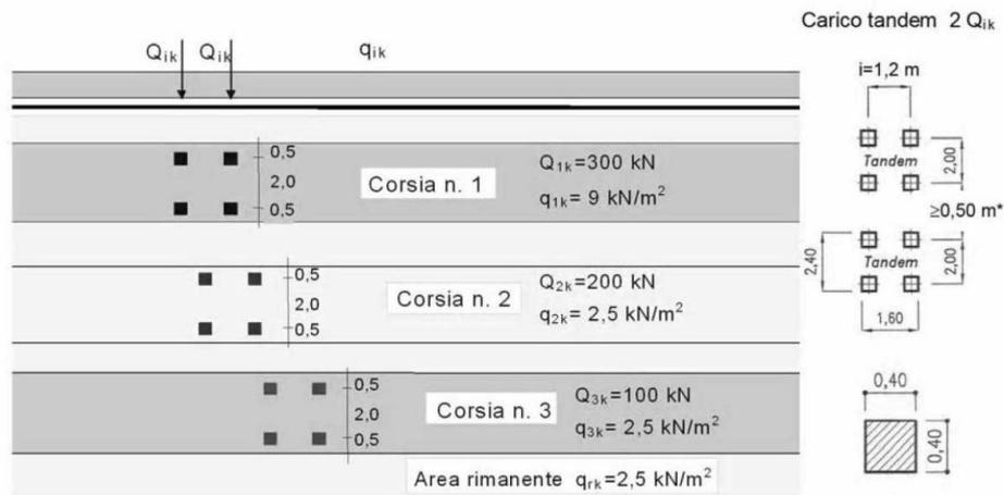
**Figura 7: Schema di carico 1**
