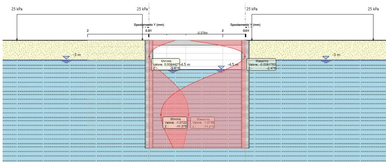
**Figura 12 - Involuppo spostamenti allo SLE. |umax|=2.96 mm**
