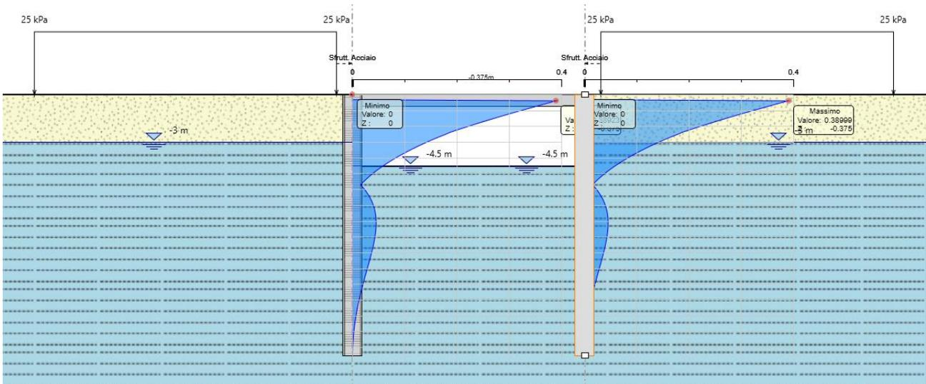
**Figura 17 - Verifica tensioni di esercizio nell'acciaio**
