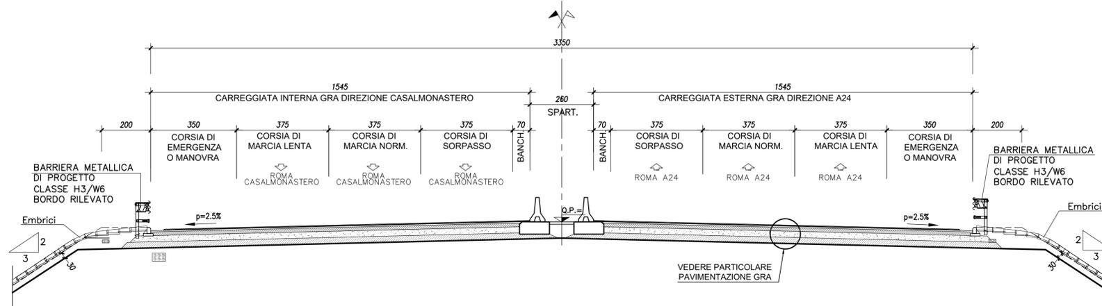
SEZIONE TIPO VIA TIBURTINA SOTTO PONTE GRA - Scala 1:100
