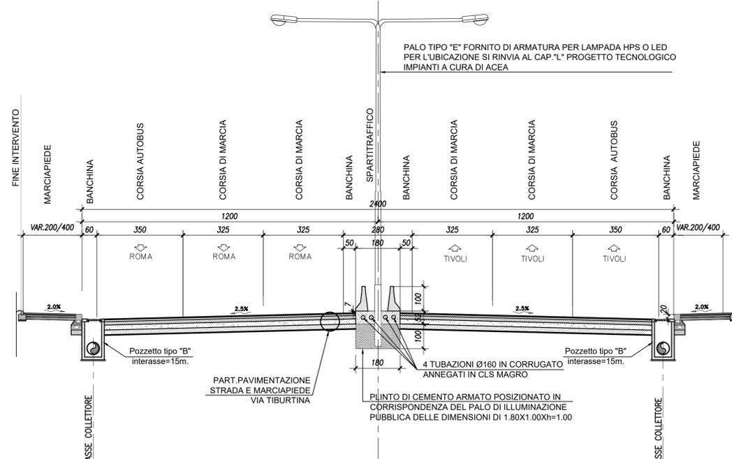
PARTICOLARI DELLE PAVIMENTAZIONI - Scala 1:20
