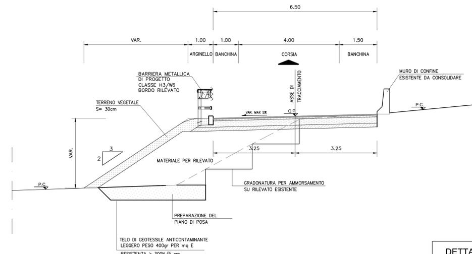
SEZIONE RAMPA EST CON MURO IN TERRA RINFORZATA RINVERDITA
