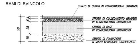
SEZIONE RAMPA DI SVINCOLO DA ADOTTARE PER NOTEVOLI ALLARGAMENTI
