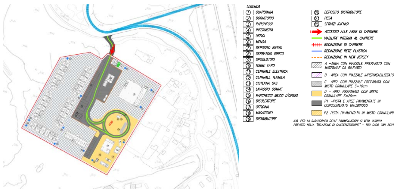
Figura 34 – Planimetria cantiere base
