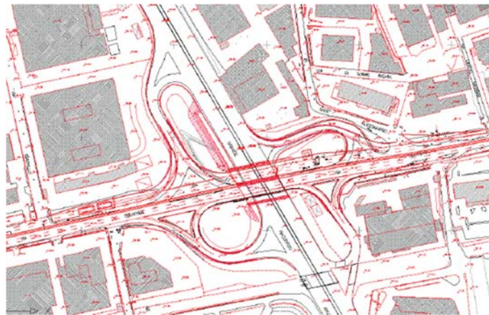
Figura 3 – Planimetria interventi adeguamento svincolo Tiburtina
