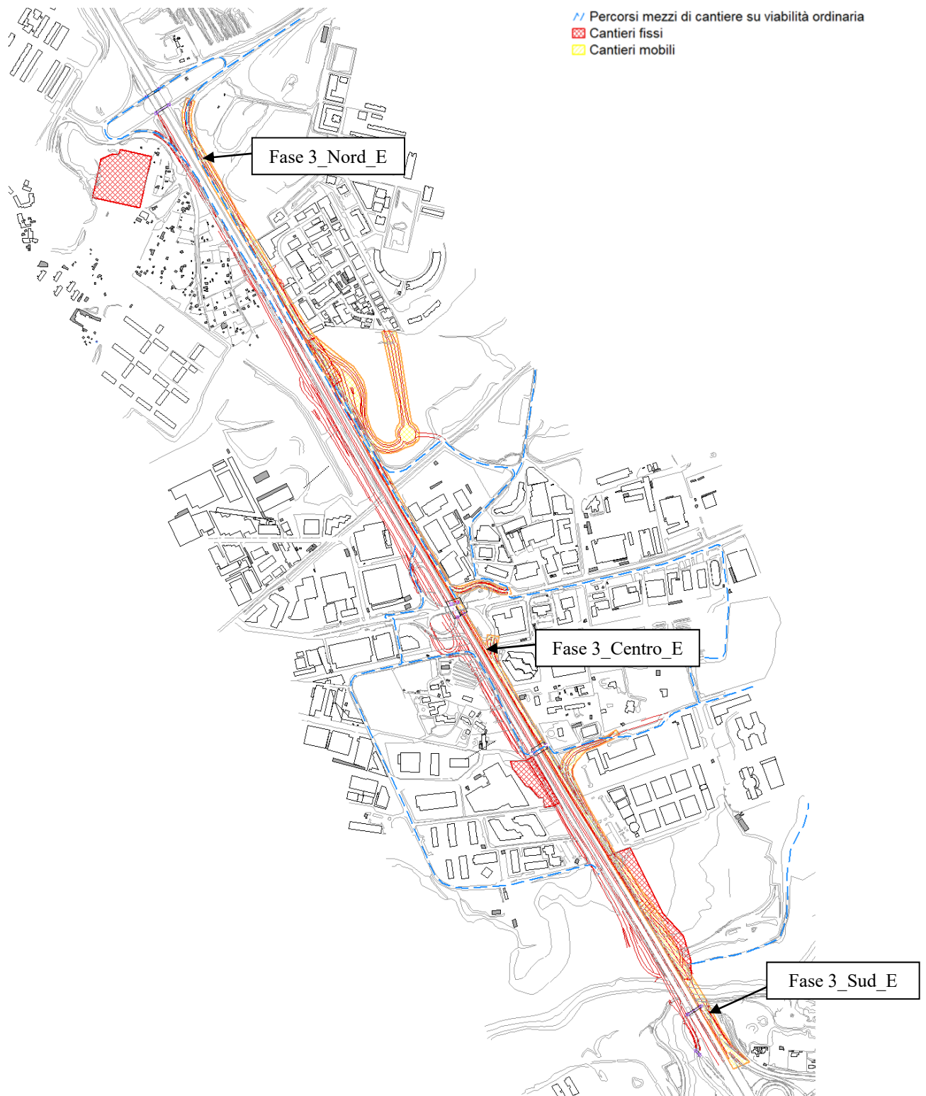
Figura 60 - Ubicazione aree di cantiere mobili fase 3
