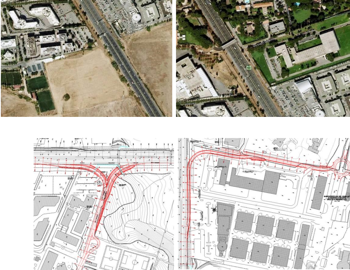
Figura 23: Confronto tra stato di fatto e stato di progetto in corrispondenza delle rampe est e ovest
