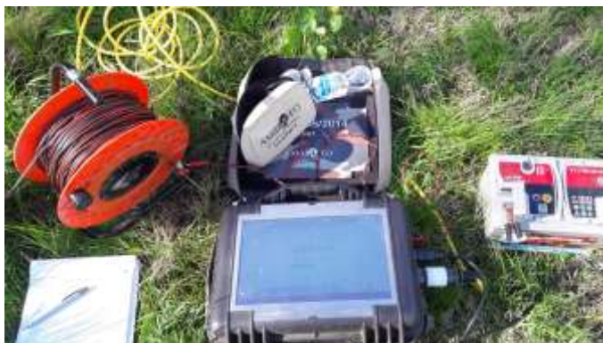
Figura 2.1.1.1: Sismografo digitale a 24 bit.
