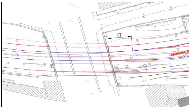
Cavalcaferrovia Via Appia Nuova (in blu i binari esistenti ed in rosso quelli di progetto)
