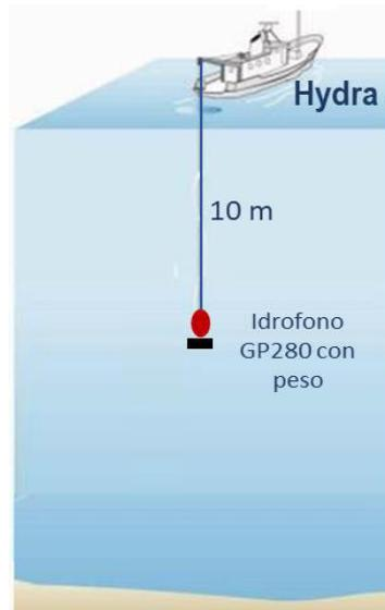
**Figura 6. Schema del posizionamento del sensore acustico su imbarcazione Hydra.**
