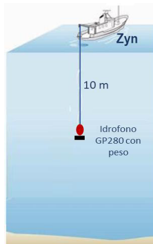
Figura 5: Schema del posizionamento del sensore acustico su imbarcazione Zyn.
