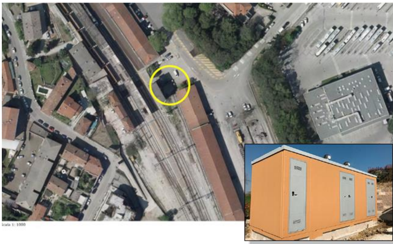
Figura 3-15: Posizionamento cabina prefabbricata. Nel dettaglio, tipologico cabina standard Enel DG2092
