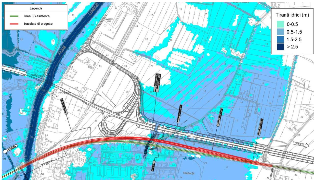
Figura 29: modello numerico 2D: aree potenzialmente inondabili, scenario post operam, Tr200.
