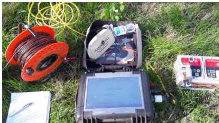
Figura 2.1.2.1: Sismografo digitale a 24 bit.
