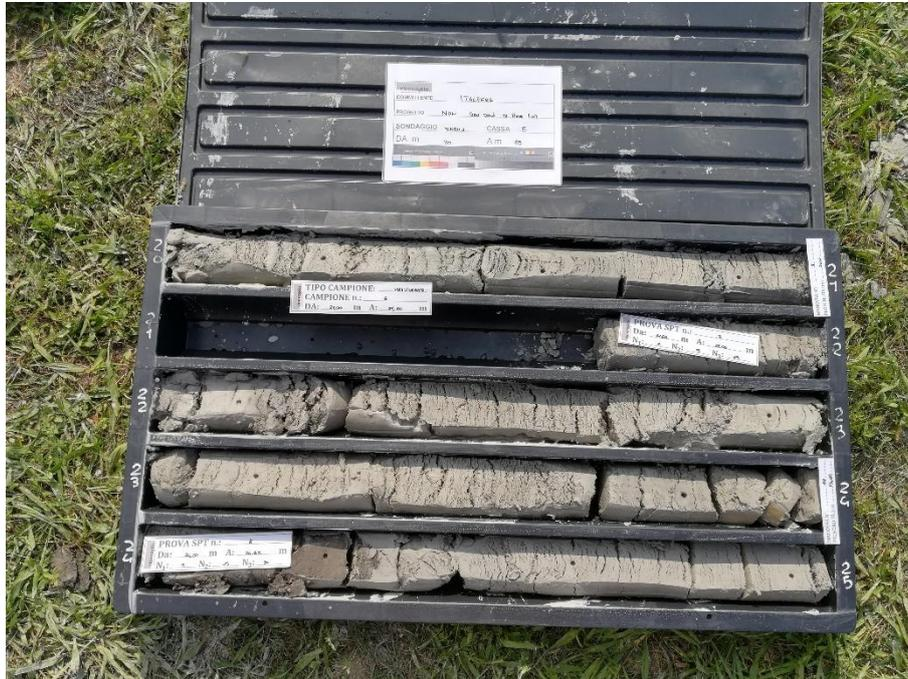
Figura 7 - Sondaggio SNPM1, profondità 20,00-25,00 m
