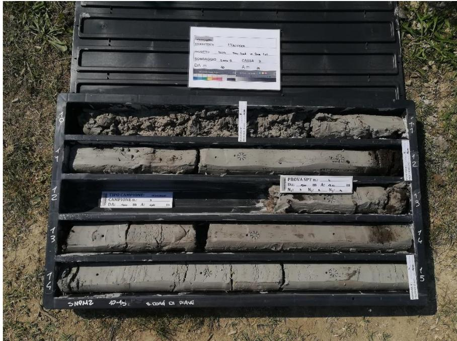
Figura 14 - Sondaggio SNPM2, profondità 10,00-15,00 m
