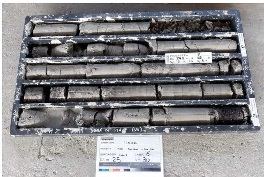
Figura 17 - Sondaggio SNPM2, profondità 25,00-30,00 m
