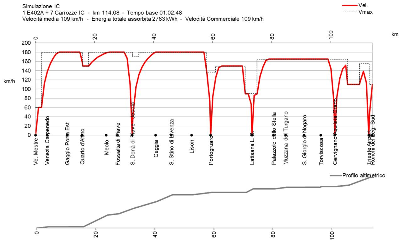
Figura 9: Simulazione di marcia servizio intercity scenario inerziale
