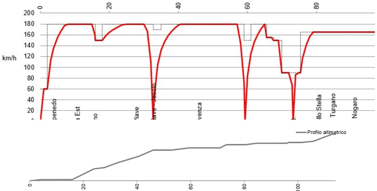
Figura 10: Simulazione di marcia servizio intercity scenario con velocizzazione
