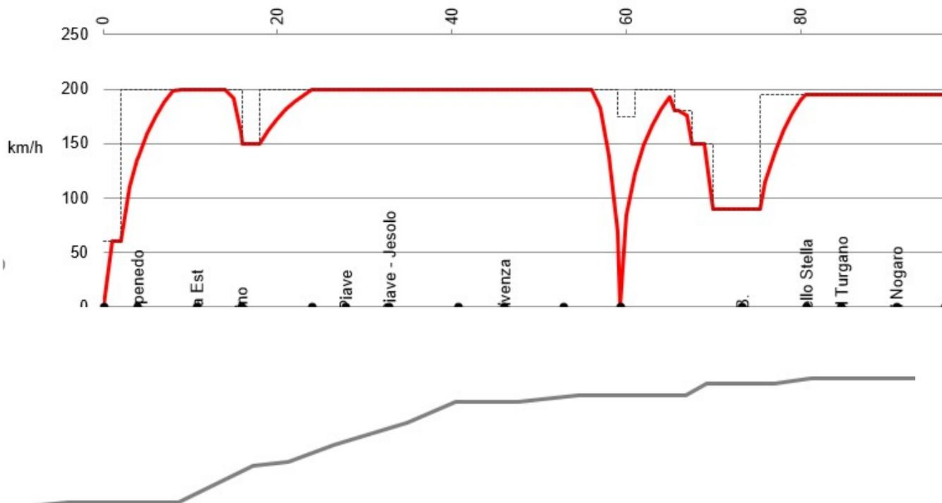
*Figura 12: Simulazione di marcia servizio lunga percorrenza scenario con velocizzazione*
