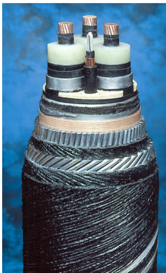
Figura B 9-3 Sezione tipica del cavo marino XLPE tripolare in rame, con schermi in piombo, armatura in acciaio e fibra ottica.
