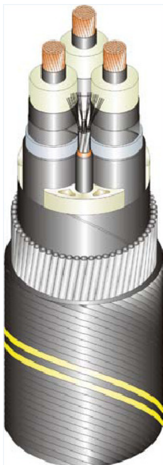
Figura B 9-3 Sezione tipica del cavo marino XLPE tripolare in rame, con schermi in piombo, armatura in acciaio e fibra ottica.
