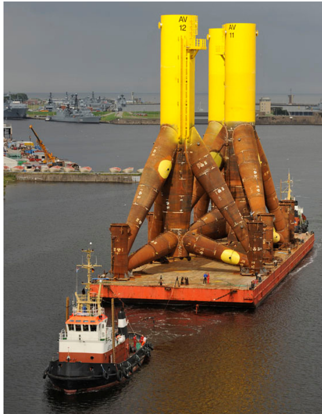
Figura B 8-3 Trasporto di 2 fondazioni a tripode tramite chiatte e rimorchiatore [http://www.alpha-ventus.de]
