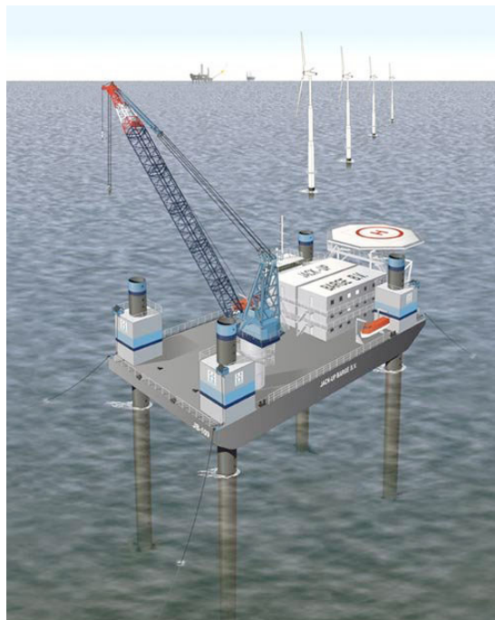
Figura B 7-2 Esempio di pontone autoportante per cantieri offshore , dotato di gru e piattaforma per l'atterraggio di elicotteri [ http://www.jackupbarge.com ]
