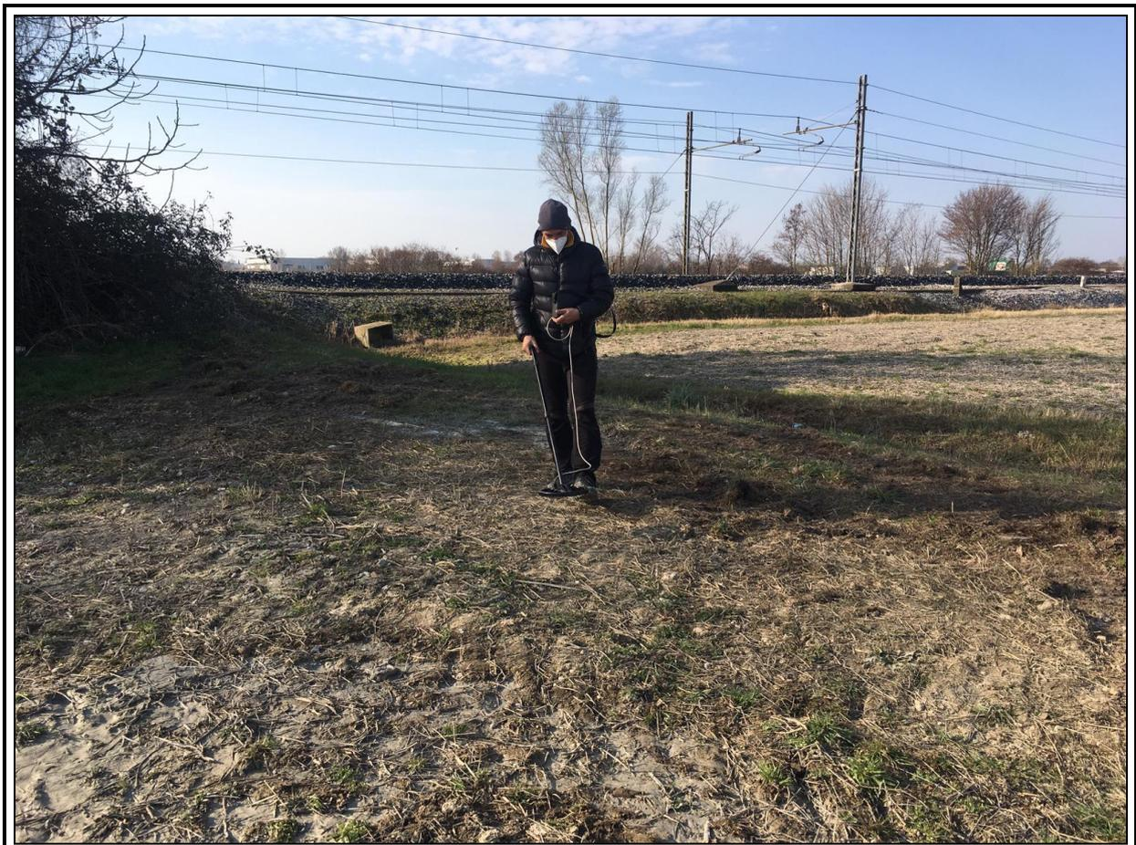
**Sondaggio PM1-Rilievo masse metalliche**
