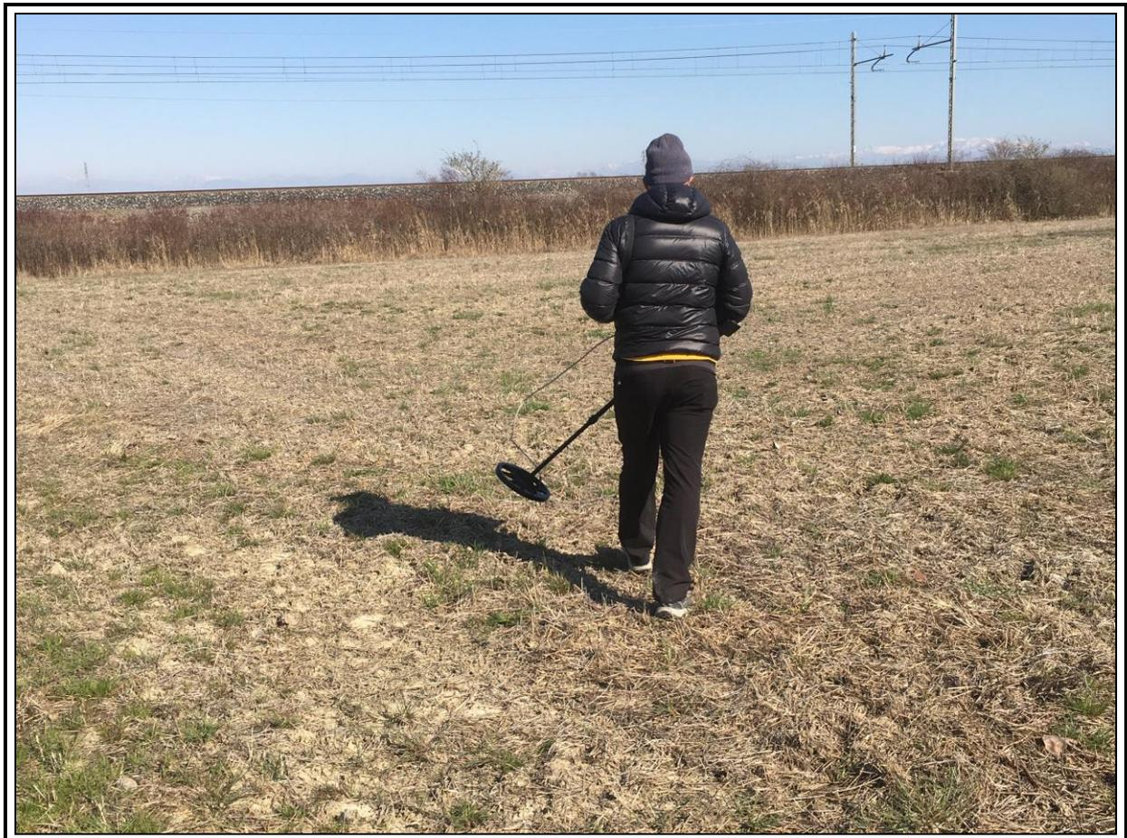
**Sondaggio PM2-Rilievo masse metalliche**
