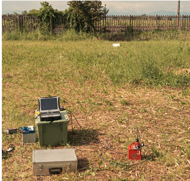
Figura 1-5 Esempio di installazione dell'accelerometro
