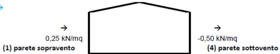
Valori medi della pressione per ogni elemento (da utilizzare per caricare il modello FEM)
