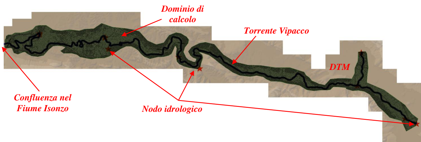
Figura 24. Torrente Vipacco, modello numerico 2D: dominio di calcolo.
