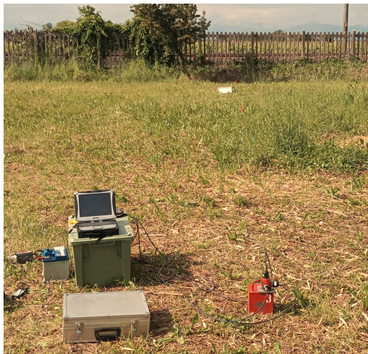
Figura 1-5 Esempio di installazione dell'accelerometro
