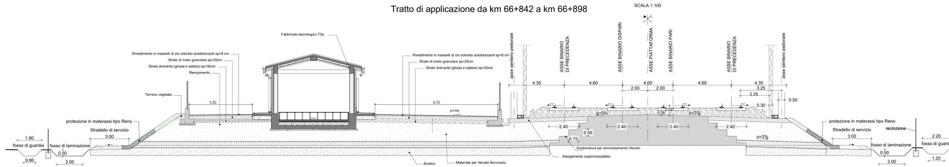
SEZIONE TIPO IN RILEVATO
