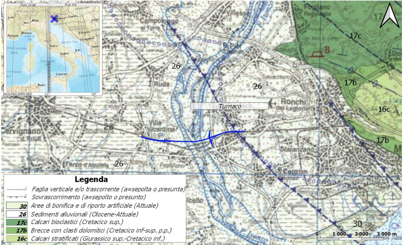
Figura 3 - Stralcio della Carta Geologica del Friuli-Venezia Giulia (Carulli 2006), con indicazione dell'opera di progetto (linea blu).
