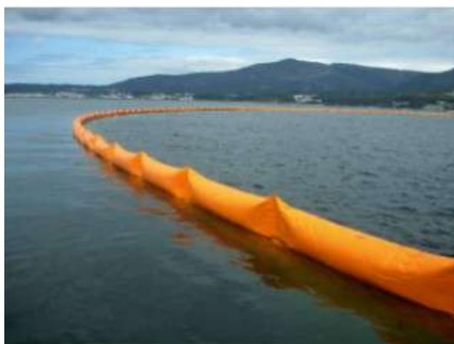
*Figura 40: Esempio di utilizzo di barriera galleggiante antinquinamento (Immagini di proprietà di CSA Distribuzione srl)*
