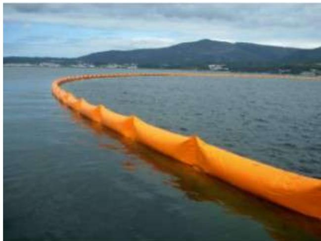
*Figura 45: Esempio di utilizzo di barriera galleggiante antinquinamento (Immagini di proprietà di CSA Distribuzione srl)*
