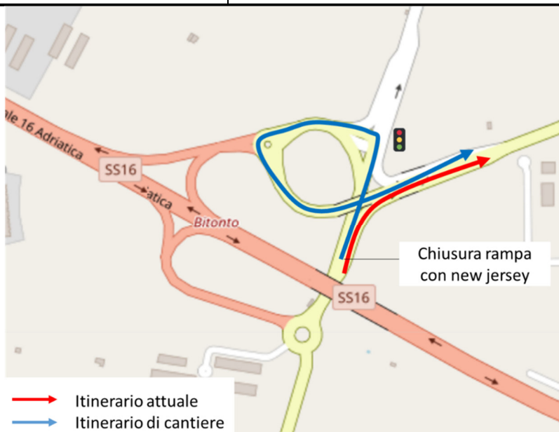
Figura 8 – Viabilità attuale e di cantiere in seguito alla chiusura della rampa di accesso alla SP91
