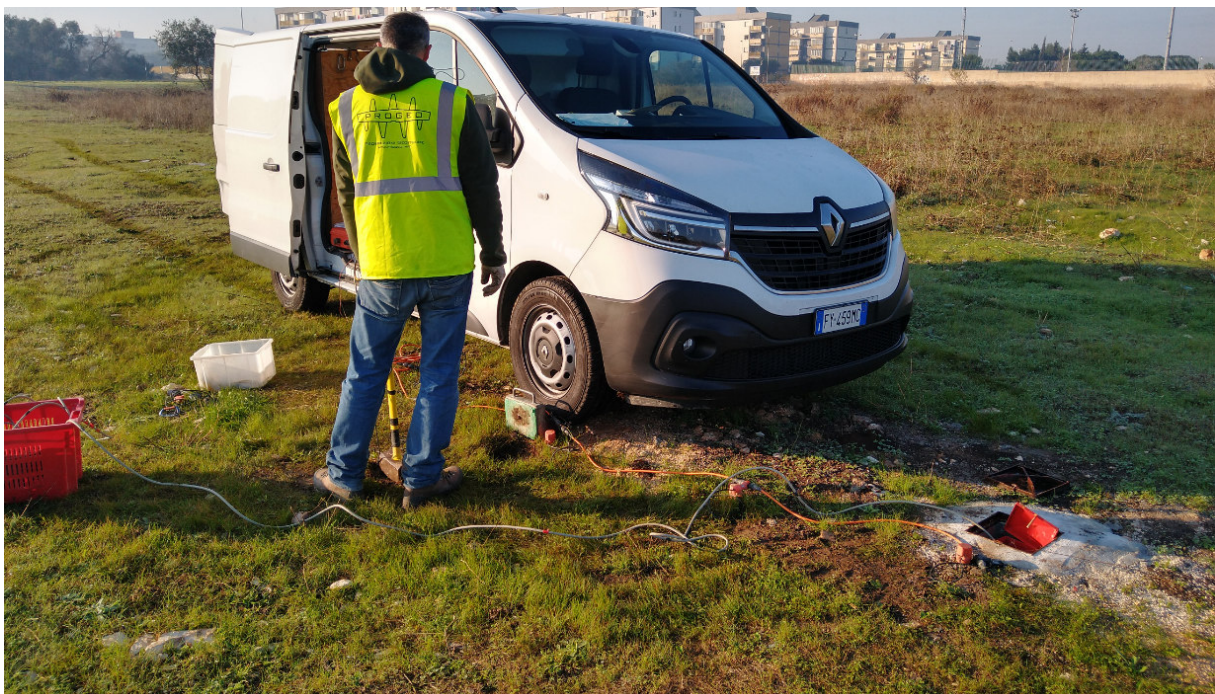
Particolare indagini in foro Down Hole GA03_
