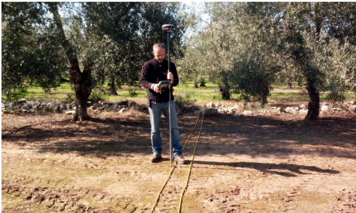
Particolare indagini elettrica tomografica TE6 e rilievo topografico con GPS Leica.
