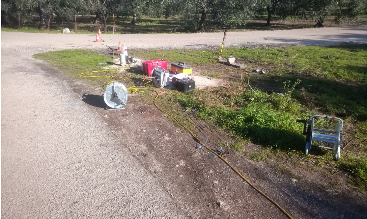
Particolare indagini elettrica tomografica TR04_ERT4 e Down Hole TR04
