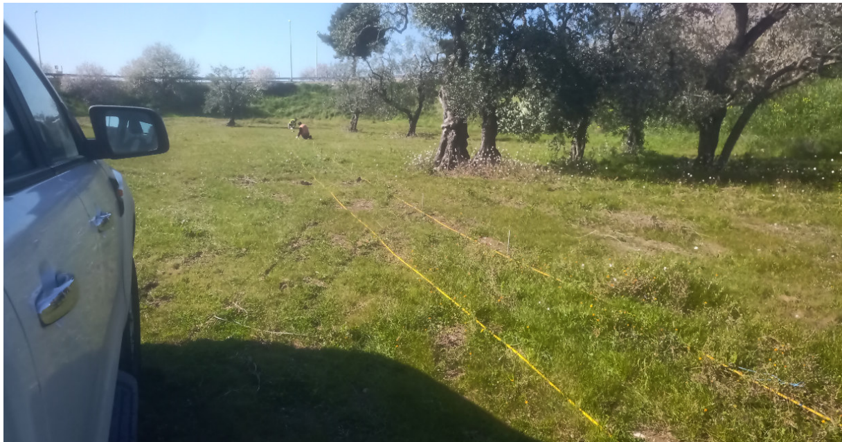
Particolare indagini elettrica tomografica TE8
