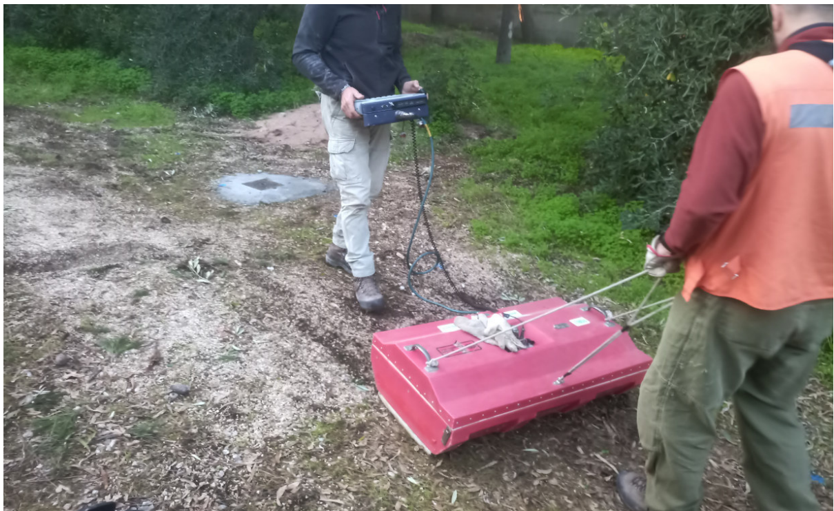
Particolare indagini Georadar linea GA01_RADAR1
