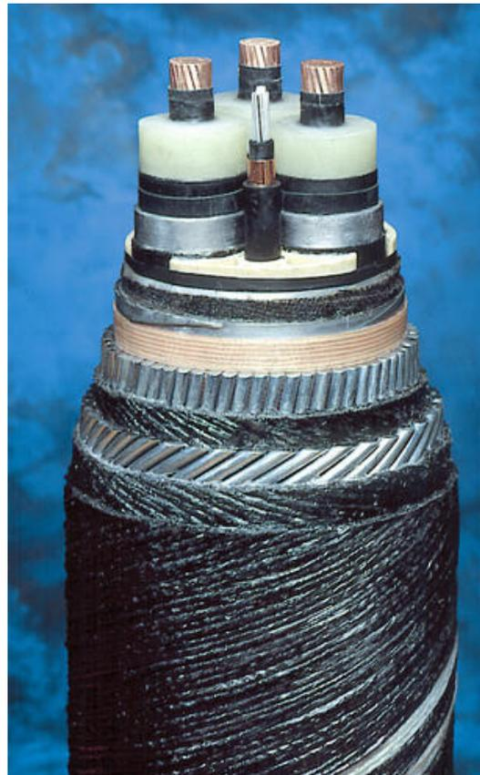
Fig. 3-4: sezione tipica del cavo marino XLPE tripolare in rame, con schermi in piombo, armatura in acciaio e fibra ottica
