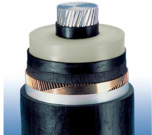
Figura A-5: Sezione tipica del cavo XLPE: 1) conduttore; 2) schermo del conduttore; 3) isolamento; 4) schermo isolante; 5) barriera antiacqua; 6) schermo metallico esterno; 7) guaina esterna
