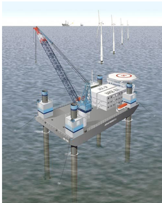
Figura 2-3 Esempio di pontone autoportante per cantieri offshore, dotato di gru e piattaforma per l'atterraggio di elicotteri http://www.jackupbarge.com
