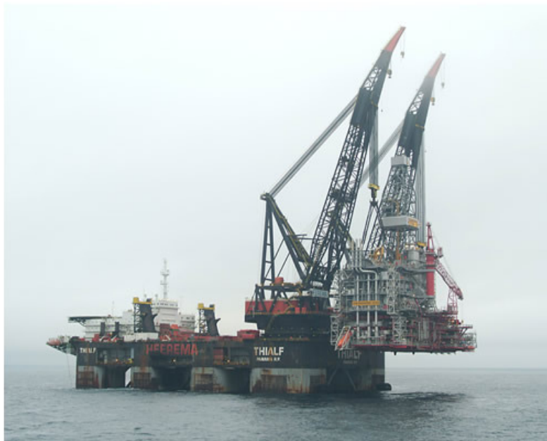
Figura 2-16 Esempio di pontone impiegato per l'installazione di una ESP offshore
