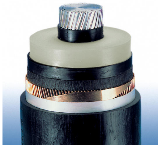
Figura 2-30 Sezione tipica del cavo XLPE: 1) conduttore; 2) schermo del conduttore; 3) isolamento; 4) schermo isolante; 5) barriera antiacqua; 6) schermo metallico esterno; 7) guaina esterna
