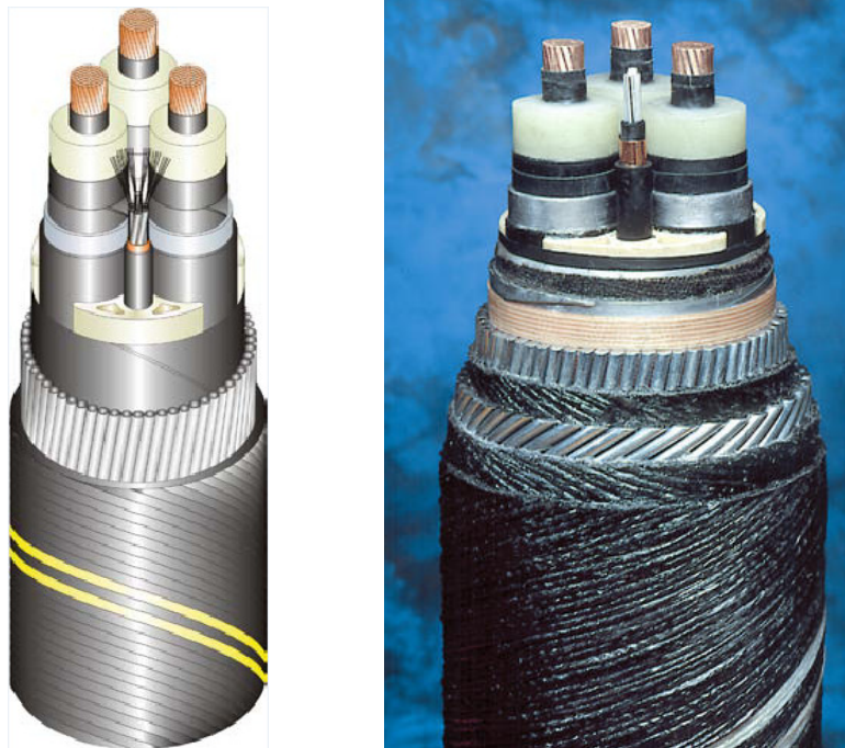
Figura 2-14 Sezione tipica del cavo marino XLPE tripolare in rame, con schermi in piombo, armatura in acciaio e fibra ottica
